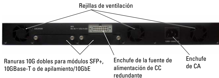
Ilustración 1-9. Panel posterior de PC7024P y PC7048P
