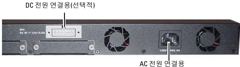
그림 1-15. 스위치에 AC 및 DC 전원 연결
